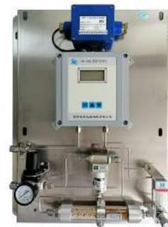
NK-202E型氧中氢分析仪采用进口传感器，反应灵敏、精确度高，结合低功耗芯片设计的信号处理电路，将被测气体中氧气的含量转化为4~20mA标准信号输出，并数字显示被测气体的氢含量；操作采用触摸按键，简单可靠；采用二线制24V DC供电；体积小、重量轻、结构合理、便于安装；适用于各种防爆场合氢气和它性气体中氢含量的在线检测分析。例如：电解水制氢过程。
