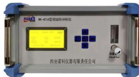
NK-401A型便携式双组份气体分析仪，是采用进口高性能传感器与新型微机技术相结合研发而成的新型智能化工业精密分析仪。可以同时精确测量多种组份气体的含量（例如：CO<sub>2</sub>和O<sub>2</sub>、CO和O<sub>2</sub>、H<sub>2</sub>和CO<sub>2</sub>、H<sub>2</sub>和O<sub>2</sub>等多种组合）可选配气泵。
