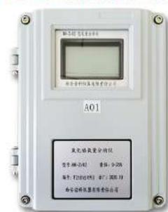
氧化锆烟气氧量分析仪是近几十年发展起来的新型测氧器，因其具有结构简单、维护方便、反应速度快、测量范围广等特点，而广泛应用于电力、冶金、供暖、建材、电子等部门，分析各种工业锅炉及窑炉中烟气的氧含量，提高燃烧效率节约能源，减少环境污染。NK-ZrO<sub>2</sub>型氧化锆氧量分析仪由转换器和检测器（俗称氧探头）组成，在检测器的核心元件氧化锆浓差电池上，采用了纳米材料和先进的生产工艺，在电极涂层上添加抑制电极老化的添加剂。大大提高了氧化锆测量探头的精度和使用寿命。检测器采用直插式探头结构，不需取样系统，能及时反映锅炉内燃烧状况，如与自控装置配合使用，可有效地控制燃烧状况。转换器采用单片机智能化设计，汉字液晶显示，使数据显示、功能控制更具有人性化；可与各类DCS数据接入设备连接。使仪表的操作变的简单，容易掌握。
