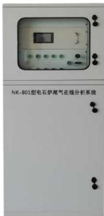
NK-801型电石炉尾气分析系统，是为电石炉运行生产，专门设计制造的分析监控系统，整套系统包括取样单元、预处理单元、分析单元、控制单元、仪器标定单元五部分。该系统可在高温、高尘的工况条件下连续运行工作，并在极短的时间内分析出炉气中CO、CO<sub>2</sub>、N<sub>2</sub>、H<sub>2</sub>、O<sub>2</sub>、CH<sub>4</sub>等各种成分含量以及热值等参数，分析仪采用红外、磁式或电化学式、热导式原理。
