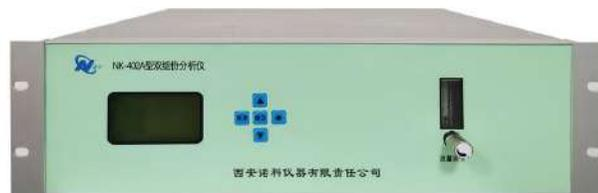
NK-402A型双组份气体分析仪，是采用进口高性能传感器与新型微机技术相结合研发而成的新型智能化工业在线分析仪。可以同时精确测量两种或多种组份气体的含量（例如：CO<sub>2</sub>和O<sub>2</sub>、CO和O<sub>2</sub>、H<sub>2</sub>和CO<sub>2</sub>、H<sub>2</sub>和O<sub>2</sub>等），而且能同时输出两组隔离的4~20mA电流信号和四组无源继电器信号。
