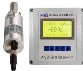
NK-303G型智能露点仪，采用进口薄膜电容式露点传感器，响应速度快，灵敏度高，稳定性好。使用操作简便。可测量各种气体中微量水分含量，适用与对水分含量有严格控制要求的各种在线分析场合。
