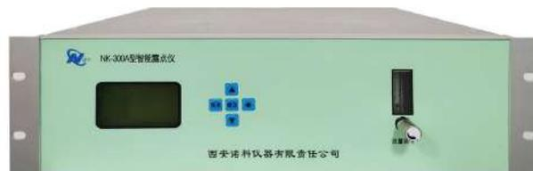
NK-300A型智能露点仪, 采用进口薄膜电容式露点传感器, 响应速度快, 灵敏度高, 稳定性好。使用操作简便。可测量各种气体中微量水分含量, 适用与对水分含量有严格控制要求的各种在线分析场合。
