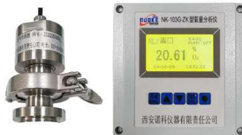
NK-103G-ZK型氧量分析仪,是我公司最新研发的新型高精度在线式氧量分析仪;该仪器采用进口高性能氧气传感器结合单片机控制技术,具有测量精度高、稳定性好、使用寿命长、使用操作简便等特点。是专门为制药设备真空环境下氧气精密测量而设计的。仪器采用128×64点阵LCD显示器,高亮度,无视角影响,直观醒目,无人职守时,可定时记录氧含量值,最多可存储3200条数据,采用触摸按键全中文菜单操作,通俗易懂、简单可靠,采用DC24V供电。
