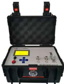
NK-301S手提智能露点仪，是以进口高精度露点传感器为核心，经过我公司二次开发完善而成，具有响应速度快，灵敏度高。采用电池供电，低功耗便携式设计，使用操作简便。可测量各种惰性气体中微量水分含量，适用于对水分含量有严格控制要求的各种场合。
