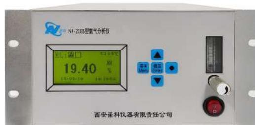
NK-210A型氩气分析仪,采用进口微流式热导气体传感器与最新微机处理技术相结合研制而成的混合气体中氩含量的工业在线分析仪器。
