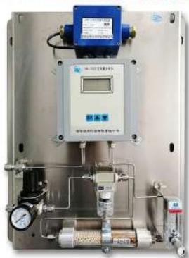
NK-102E型氧量分析仪采用进口传感器，反应灵敏、精确度高，结合低功耗芯片设计的信号处理电路，将被测气体中氧气的含量转化为4~20mA标准信号输出，并数字显示被测气体的氧含量；操作采用触摸按键，简单可靠；采用二线制24V DC供电；体积小、重量轻、结构合理、便于安装；适用于各种防爆场合氢气和它性气体中氧含量的在线检测分析。例如：电解水制氢过程。
