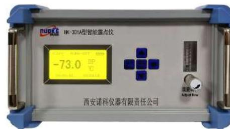
NK-301A型智能露点仪（微量水分分析仪），采用进口高分子薄膜电容露点传感器，响应速度快、灵敏度高，直流供电低功耗便携式设计，使用操作简便。可测量各种惰性气体中微量水分含量，适用于对水分含量有严格控制要求的各种场合。
