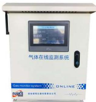
NK-M60厂界挥发性有机物TVOC在线监测系统，主要原理是利用挥发性有机物TVOC气体扩散运动，采用PID光离子传感器信号分析技术，可实时监测厂界挥发性有机物TVOC浓度，能够替代人工检测方法，满足全天候无人值守监测污染物的目的，提供实时的监测数据、趋势变化、报警信息等功能，通过无线传输模块将监测数据实时传输至当地环保局平台或其他云平台，同时还可集成气象参数等。
