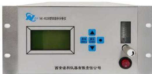
NK-402B型多组份气体分析仪，是采用进口高性能传感器与新型微机技术相结合研发而成的新型智能化工业精密分析仪可以同时精确测量两种或多种组份气体的含量（例如：CO<sub>2</sub>和O<sub>2</sub>、CO和O<sub>2</sub>、H<sub>2</sub>和CO<sub>2</sub>、H<sub>2</sub>和O<sub>2</sub>等多种组合）可选配气泵。
