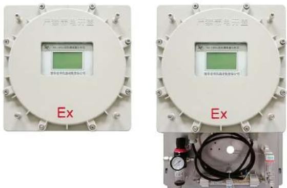
NK-100Ex型防爆式氧量分析仪,采用进口高性能电化学传感器与新型微机技术相结合研发而成的新型智能化工业在线分析仪。适合于各种防爆场合。同时可根据客户要求及工况的复杂程度选用磁压式氧传感器、激光式氧传感器或固体电解质式(氧化锆、离子流)氧传感器。
