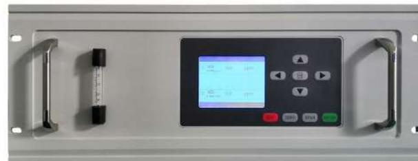
NK-550A型一氧化氮/二氧化氮分析仪, 采用进口传感器, 响应速度快, 灵敏度高, 稳定性好。是以紫外差分吸收光谱技术为核心的新型产品, 主要用于排气管道中有害气体成分的测量, 广泛应用于环境监测以及热工参数测量等部门。该分析仪性能指标均符合国家环保局颁布的烟气测试仪的有关规定, 检测结果不受烟气中水蒸气影响, 具有较高的测量精度和稳定性。
