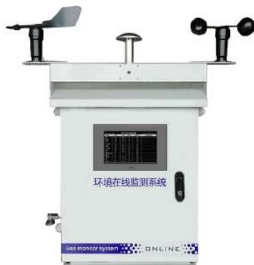
NK-M70是一款高端多功能环境空气质量监测仪，是一套以自动检测-分析-监控为核心的工业级互联网多参数在线环境监测系统。系统采用原装进口高分辨率环境监测传感器+英国原厂推荐信号处理电路（ISB）对VOCS、NO<sub>2</sub>、SO<sub>2</sub>、CO、O<sub>3</sub>、NH<sub>3</sub>、PM<sub>2.5</sub>、PM<sub>10</sub>等被监测物质进行实时监测，同时系统集成气象模块对监测环境中的温湿度、恶臭、风速、风向、噪声等气象参数进行监测。本系统符合国家对城市环境空气自动监测系统的各项技术指标要求，具有工业化设计高精度，性能稳定可靠等优势。可适用各类户外监测应用环境，包括城市大气环境监测、工业园区环境监测、隧道交通环境监测、景区公园环境监测、以及建筑扬尘监测等应用。
